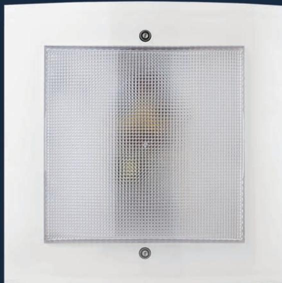
Топовая серия светильников «Интеллект-ЖКХ» LED с дежурным режимом и опто-акустическим датчиком отвечает запросам самых требовательных пользователей. Светильники этой серии поддерживают постоянное дежурное освещение (20% мощности) в темноте и переходят на полную мощность при возникновении шума, звука шагов, и т.п. Они наиболее востребованы в местах, где нет естественного освещения. Светильники имеют степень защиты IP54 и могут эксплуатироваться под козырьком при входе в подъезд.
